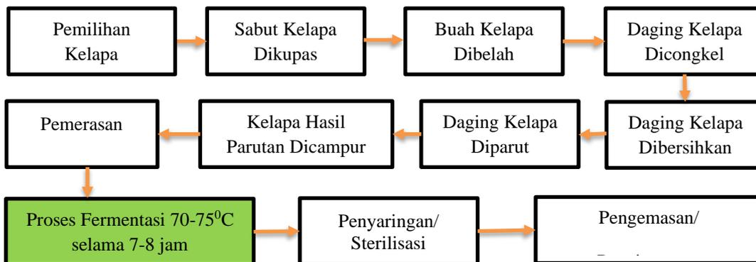
**Gambar 4.** Alur Proses Pembuatan VCO Alamiah
