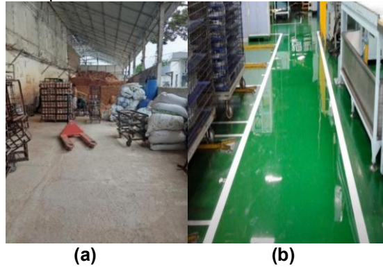
(a) (b) Gambar 2. Perbandingan tumpukan keranjang tanpa marka (a) dan dengan marka (b)
