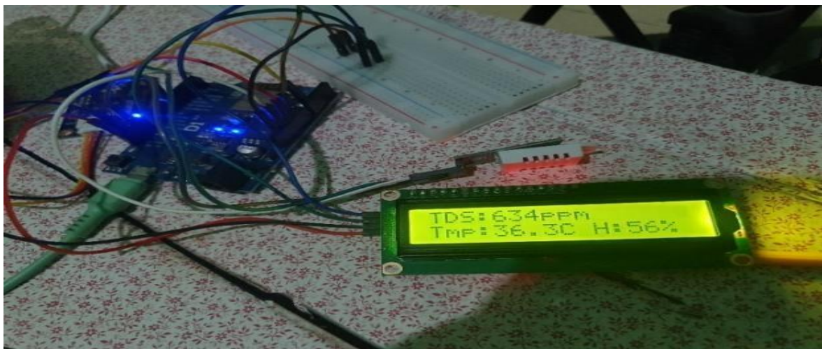
Gambar 11. Pengujian LCD 16x2.
