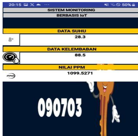
Gambar 7. Pengujian aplikasi pada perangkat smartphone andorid.
