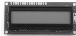
Gambar 2.9 Bentuk fisik LCD 2x16
