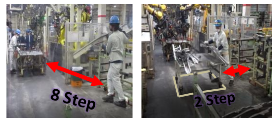
Gambar 7. Perubahan tata letak dolly transfer
