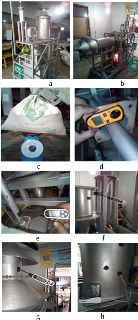
Gambar .4. Pengujian mesin pengering gabah, (a) tipe vertikal, dan (b) tipe horisontal, (c) massa gabah, (d) kecepatan aliran udara input , (e) temperatur output alat penukar kalor, (f) temperatur output cyclone , (g) output ruang pengering, (h) ruang pengering
