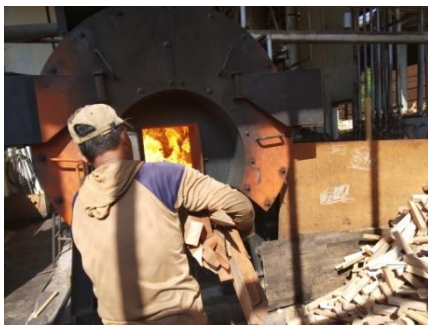
Gambar 2. Proses pembakaran untuk pengeringan kayu
